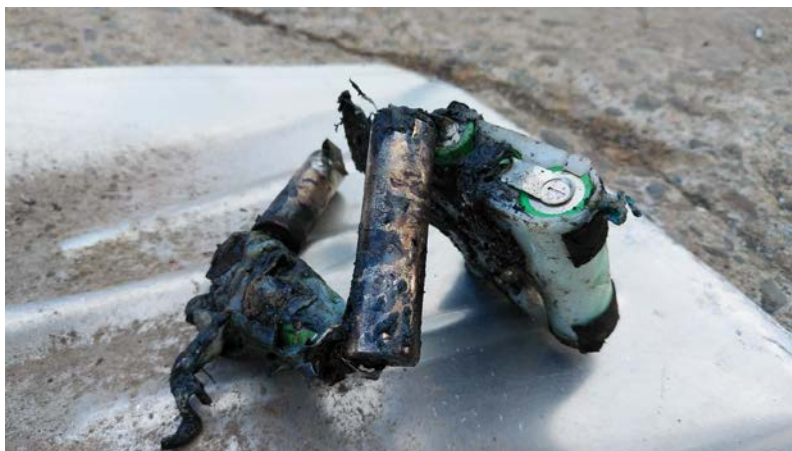
発火したリチウムイオン蓄電池
